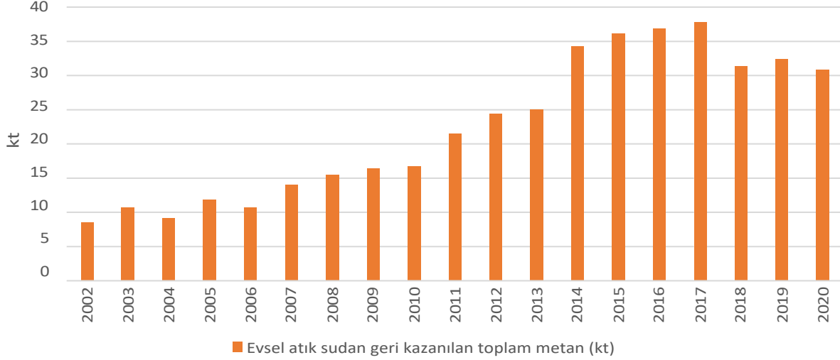
Şekil 26 - Atık su arıtma tesislerinde geri kazanılan metan (2002-2020) 53
