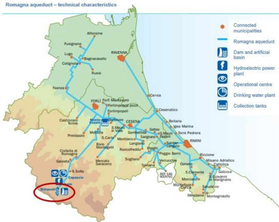
Şekil 4.8. Ridracoli barajı ve Romagna bölgesi su kemeri
