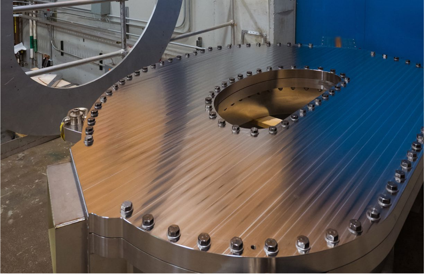
Commonwealth Fusion Systems tarafından geliştirilen yüksek sıcaklık süperiletken (HTS) mıknatıs
