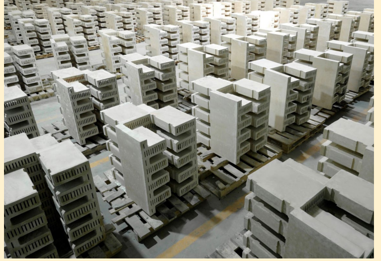
Rondo Energy ısıyı depolamak için refrakter tuğlalar kullanıyor
