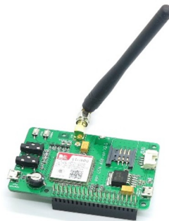
Şekil 8. GSM Modem Kartı GSM Modem Kartı
