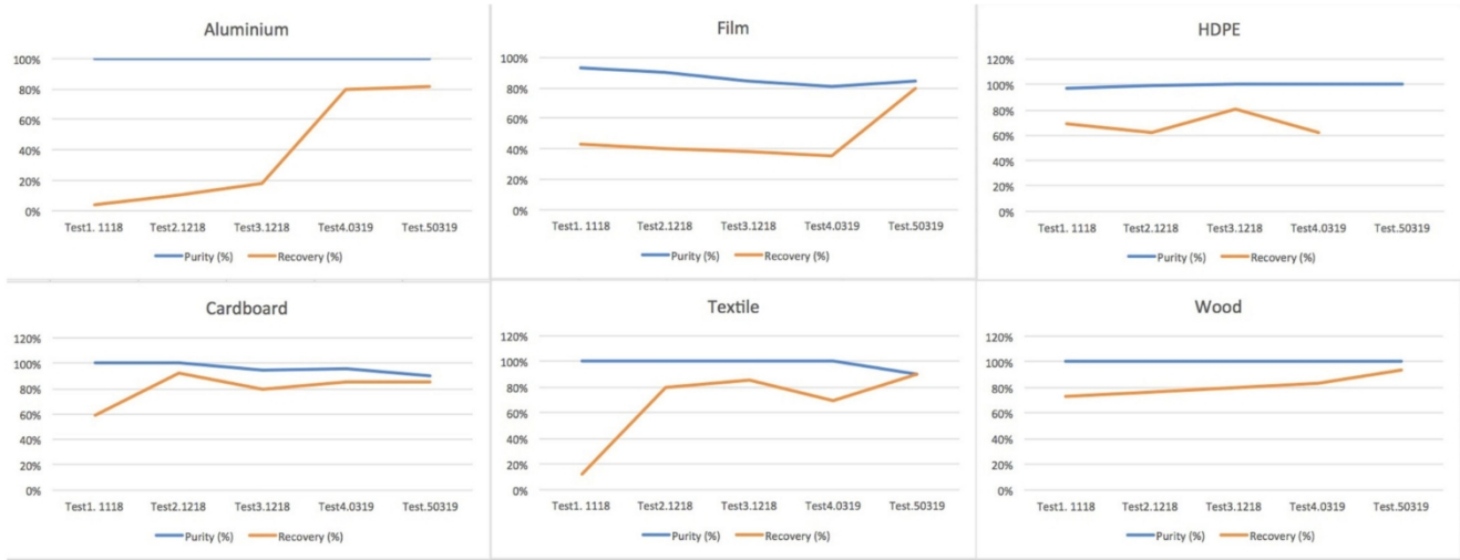
Şekil 4. Alüminyum, film, HDPE, karton, tekstil ve ahşap için eğitim testi sonuçları [15].
