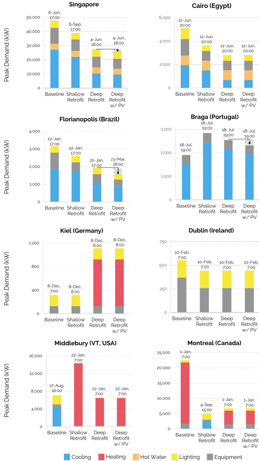
Şekil 3 | %100 çatı fotovoltaiklerinin konuşlandırılmasını da kapsayan temel, sıg ve derin iyileştirme senaryoları için yıllık bina bazlı elektrik zirve talebi. Her senaryonun üzerindeki zaman damgası, bu zirvenin meydana geldiği yılı ve saati belirtir. Çatı PV'sinin konuşlandırılmasının, zirveyi azaltmadığını gözlemliyoruz.
