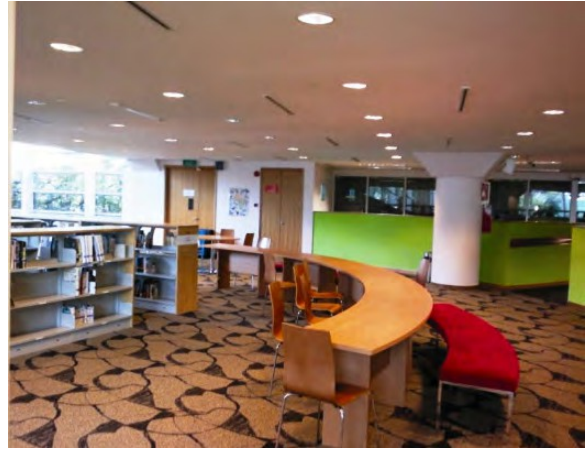
Şekil 4.8.4: Bölge kontrolü, pencereye yakın kütüphane alanının gün ışığından yararlanmasını sağlarken (solda), pencereden uzak alan CFL'lerle aydınlatılmaktadır
