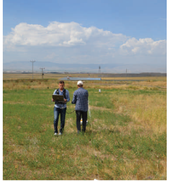
İnceleme alanında hendek yeri seçiminden önce gerçekleştirilen yer radarı çalışmasından görüntüler.
