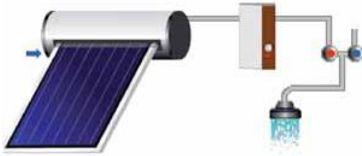
ŞEKİL 2-7: TÜRKİYE'DE YAYGIN KULLANILAN EV TİPİ SICAK SU TERMOŞİFON REFERANS SİSTEMİ.
